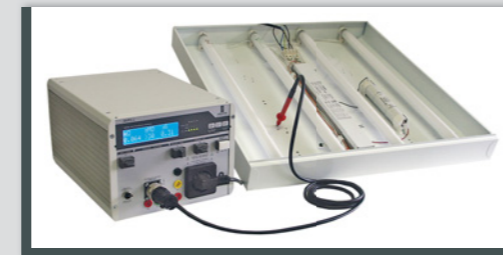
Luminaire testing: PE | ISO | function
