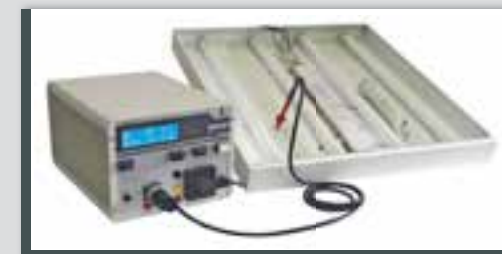
Luminaire testing: PE | ISO | function
