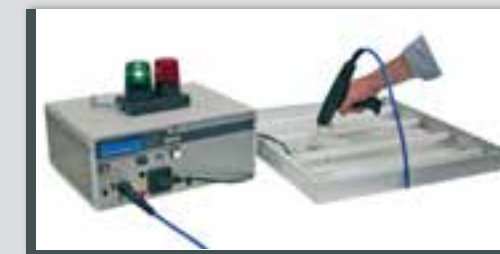
Luminaire testing: PE | ISO | HV | function
