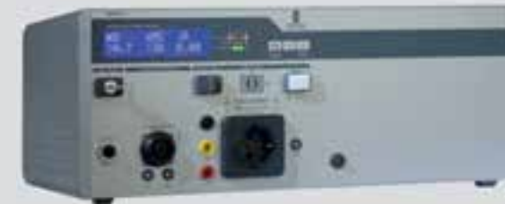
Luminaire testing: PE | ISO | HV | function
