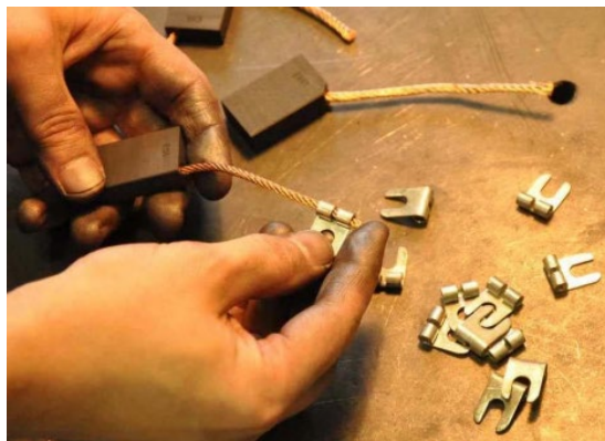
Liittimien asennus ja tinaus
