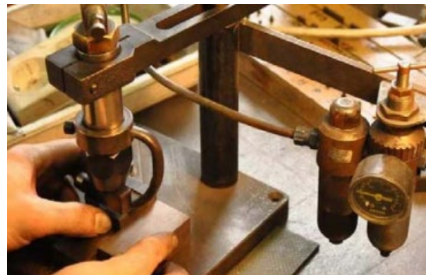
Leimaus ja lakilevyjen asennus
