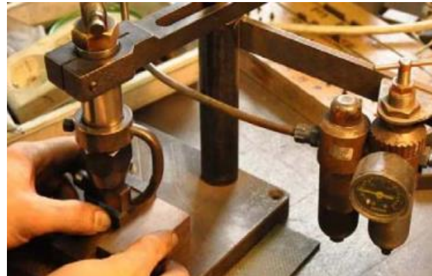
Leimaus ja lakilevyjen asennus
