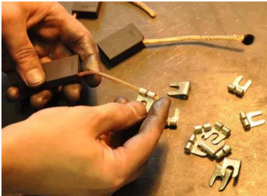
Liittimien asennus ja tinaus
